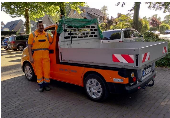
Abb.: April 2022: Nissan e-NV200 als Umbau zu einem Kipper mit Anhängerkupplung, Einsatzgebiet überwiegend örtliche Grünpflege
