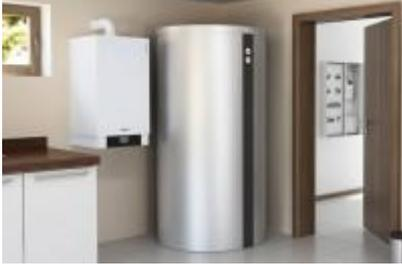
KWK-Therme Vitotwin 300-W Das Vitotwin 300-W erreicht seine elektrische Nennleistung von einem Kilowatt bei der Bereitstellung von etwa 5,3 bis 5,5 kW Heizleistung. Ein integrierter modulierender Brennwertspitzenlastbrenner stellt im Vitotwin 300-W zusätzliche 20 kW Heizleistung bereit, so dass die Gesamtheizleistung rechnerisch etwa 25 kW beträgt.
