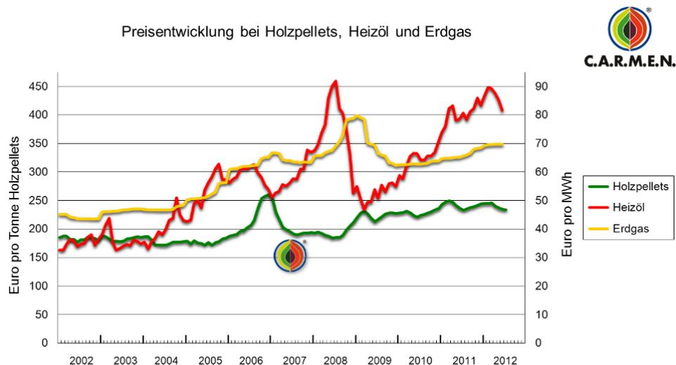
Bei Gesamtinvestitionen von gut 17.000 Euro (ohne MWST und ohne Abzug von Fördermitteln) für eine Pelletheizung in einem EFH ergeben sich bei einem Pelletpreis von 235 Euro/t (incl. MWST) Vollkosten bei der Wärme von jährlich 2.443 Euro (9,77 ct./kWh). Die Jahreskosten für eine Erdgasbrennwertheizung liegen mit 2.090 Euro (8,36 ct./kWh) knapp 15% niedriger.
