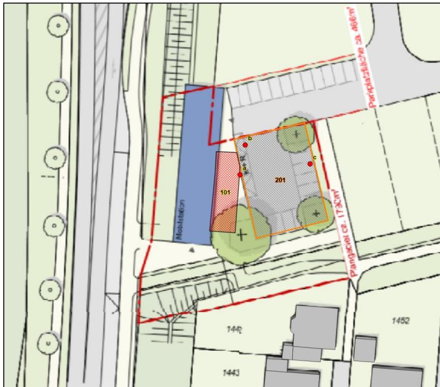
Abbildung 4: Übersicht über die relevanten Schallemissionsquellen der Mobilstation mit Café (Quelle 101 = Kommunikationsgeräusche im Freien, Quelle 201 = Parkplatzgeräusche) sowie der Packstation
