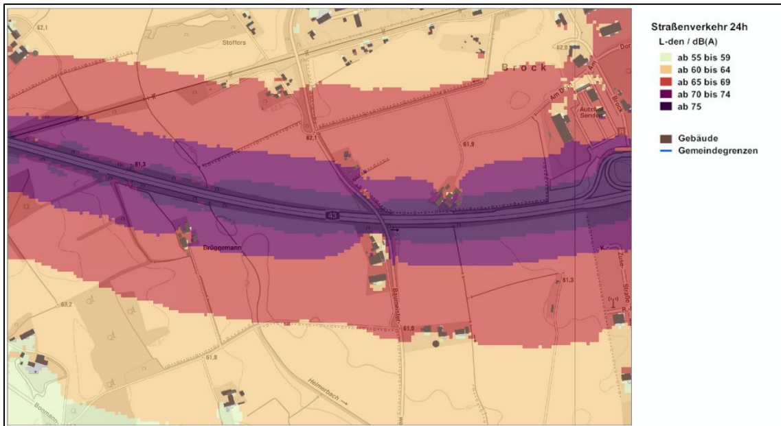
Abb. 6: Lärmbelasteter Abschnitt der BAB 43 im Ortsteil Bösensell - L_{den}/14/
